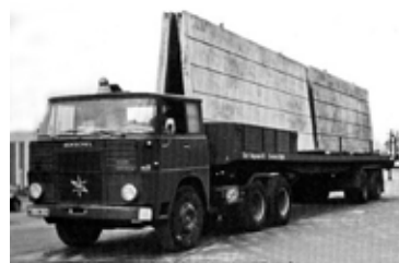
HS 22 TS beim Transport von Betonfertigteilen mit einem Auflieger von Weißenberger
