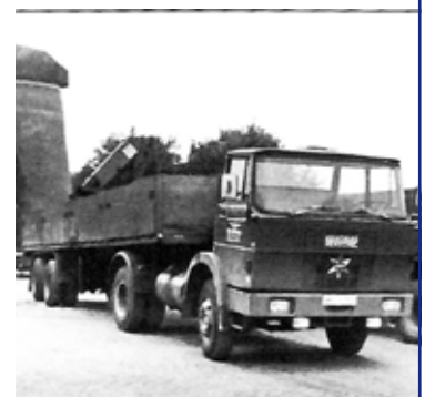
Steinzug mit bordeigenem Ladekran auf Hanomag-Henschel F 161 Zugmaschine
