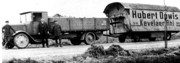
1928 schafft Hegmann den ersten Neuwagen an, einen Henschel 6 C mit Kardanantrieb. Am Kühler leibnt Gerhard Hegmann, Karls jüngster Bruder. In der Mitte stehen Hubert Opwis, der Besitzer des Anhängers und Wilhelm Janssen. Der Möbelwagen war wohl vorher im Pferdezug eingesetzt, da er an der Front noch einen Kutschbock trägt.
